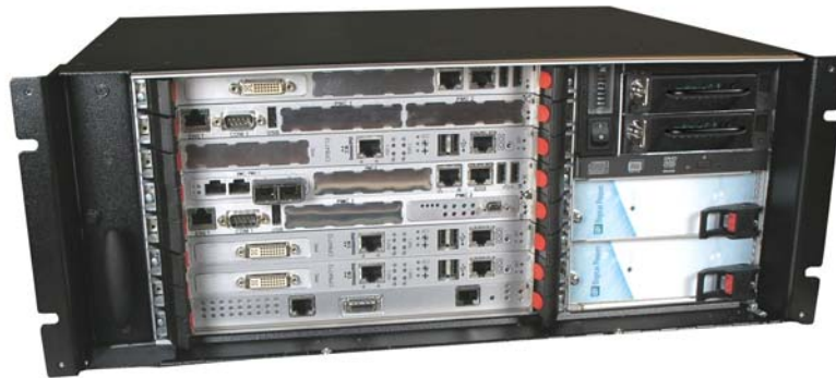
PLEXSYS-4D : DTI's 4U CompactPCI Platform
